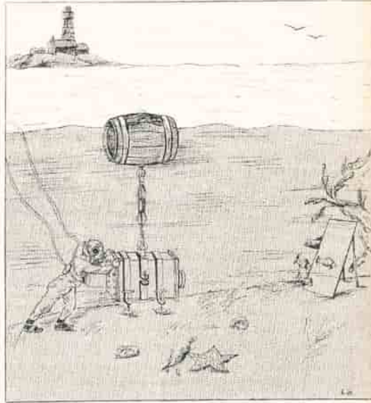
DISPOSITIF IMAGINÉ PAR M. BOUTAN POUR LA PHOTOGRAPHIE SOUS-MARINE (Manœuvre de l'appareil allégé par un flotteur.)
