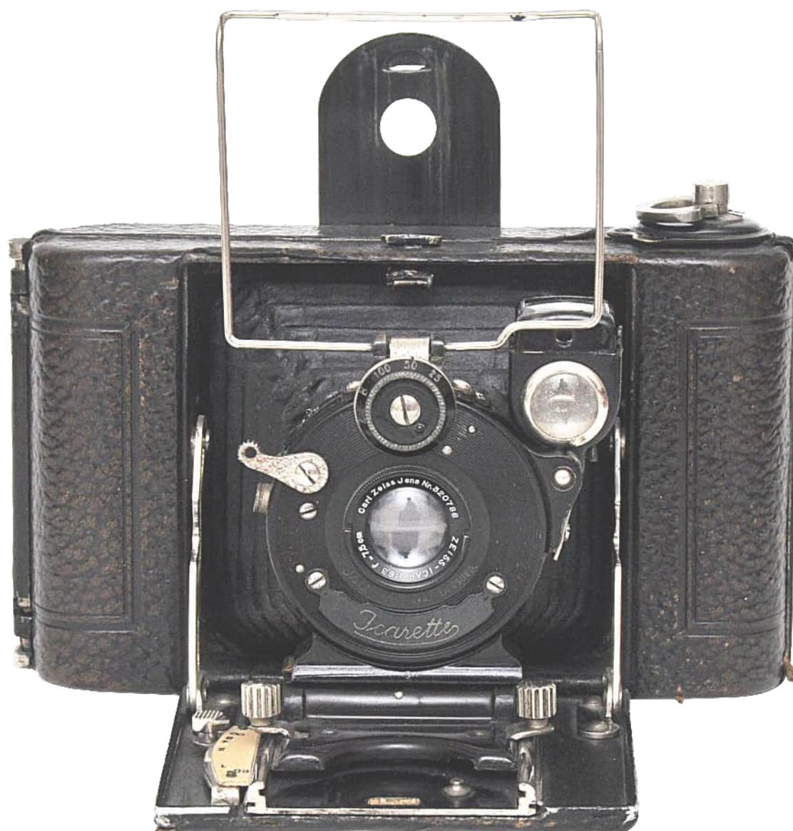
La quatrième petite merveille est l'Icayette, appareil pour pellicule au format 6 X 6 cm, fabriqué par Ica AG à Dresde en 1918. Cette date découle du n° de série de l'objectif, un Zeiss-Icar 6,3/75 cm. L'obturateur automatique avec les vitesses 1/25<sup>e</sup>, 1/50<sup>e</sup>, 1/100<sup>e</sup> et les poses B et Z correspond à un obturateur Derval de chez Alfred Gauthier.
