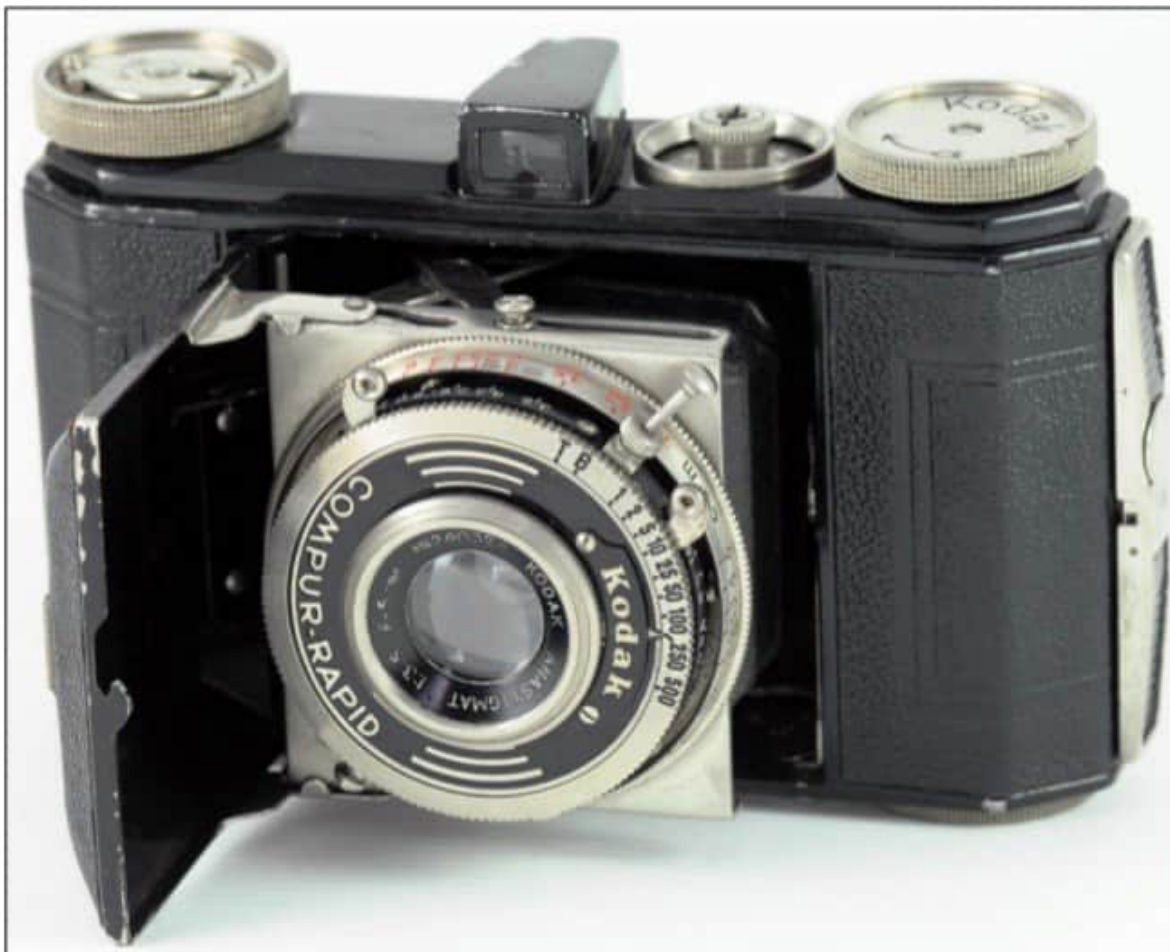
Retina Nr.118 – Boitier N/S 486252 équipé d'un objectif KODAK ANASTIGMAT I:3.5 F=5cms № 240324.
