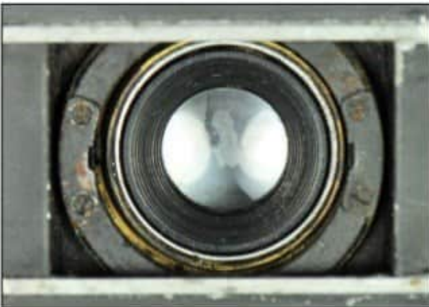
Monture arrière de l'objectif KODAK ANASTIGMAT 1:3.5 5cms 241683. La finition présente des cercles concentriques, sans rainures.
