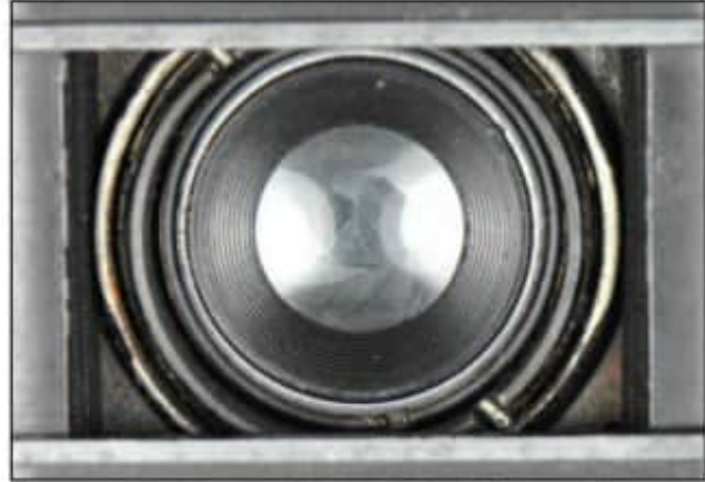
Monture arrière de l'objectif KODAK ANASTIGMAT 1:3.5 5cms № 240324. La finition présente des cercles concentriques, sans rainures.
