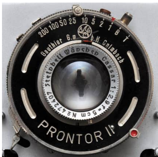
Obturateur Prontor II avec un objectif Steinheil Cassar
