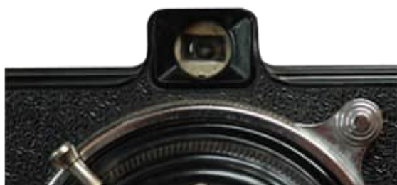
Visueur pour le format 6x9 cm seul ; pas de petites encoches pour délimiter le format 4,5x6 cm.
