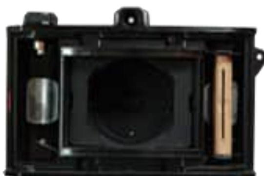
Visueur pour le format 6x9 cm seul ; pas de petites encoches pour délimiter le format 4,5x6 cm.
