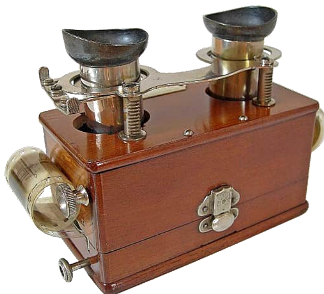
Ce modèle est cité dans les catalogues Jules Richard dès la commercialisation de l'Homéos en 1921 : « Stéréoscope d'Homéos, en bois, avec mise au point, écartement des oculaires variable »
