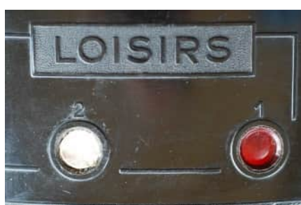
A gauche, fenêtre 2 pour l'avancement du film obturée par un papier translucide blanc maintenu par une rondelle de plastique rouge qui semble en matière identique à celle de l'obturateur rouge de la fenêtre 1.
