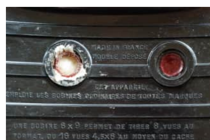
A gauche, fenêtre 2 pour l'avancement du film obturée par un papier translucide blanc maintenu par une rondelle de plastique rouge qui semble en matière identique à celle de l'obturateur rouge de la fenêtre 1.
