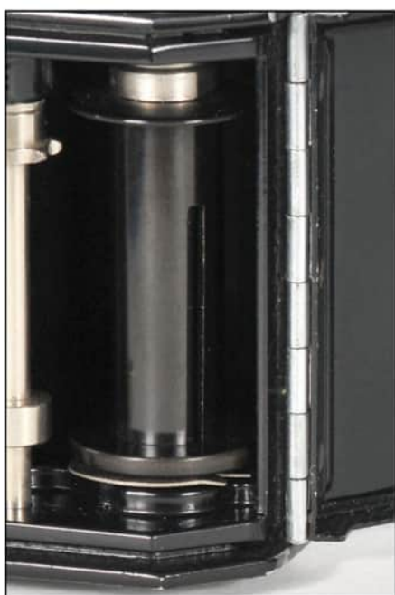
Joue inférieure moletée de la bobine réceptrice du film. Plages de numéros de série : 359041 à 381137.
