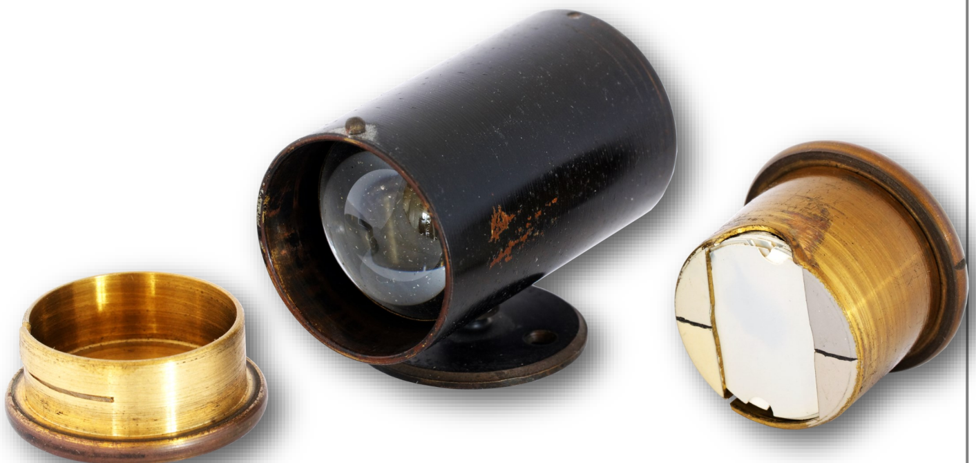
Chronoscope PAP ouvert avec son « support mobile » à visser
