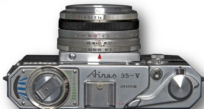
L'ensemble est bien construit, bien fini, une belle esthétique un peu anguleuse. Costaud et lourd (883 g sans pellicule). C'est le plus lourd des 8 appareils présentés. La manipulation est aisée sauf si on lâche le levier d'armement trop rapidement, il se reloge dans le capot ce qui nécessite de le récupérer (moins rapidement) pour la prise suivante.
