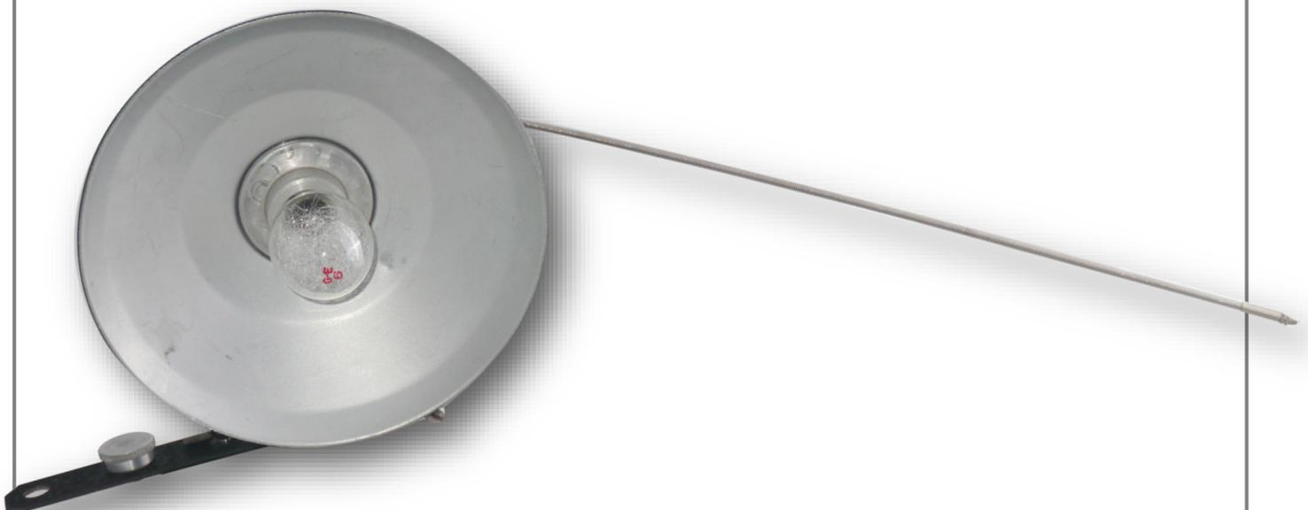
Mais le summum est le bouton situé en haut et à l'arrière du boîtier de la pile. En effet, il a un double effet : il déclenche l'obturateur (c'est bien la moindre des choses...) mais auparavant, il a mis le feu à l'ampoule de flash !
