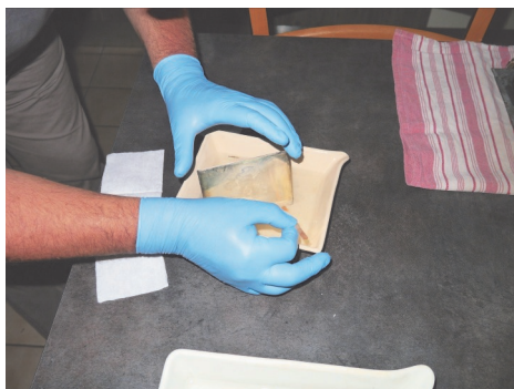
Après un contrôle visuel de l'opération, extraction avec le bâton de bois ou de plastique du daguerréotype sans toucher l'image (!).
