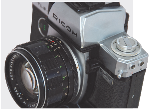
L'interrupteur de cellule, identique à celui du Pentax, et les deux prises flash.
