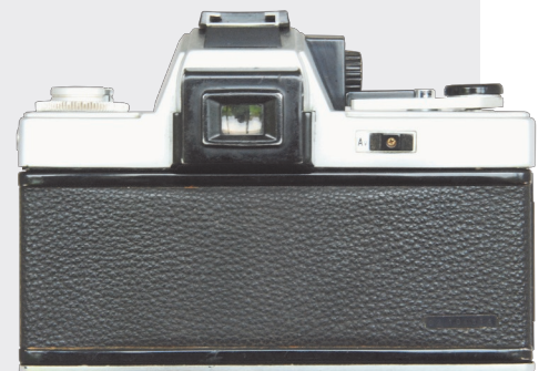
Sur la face arrière, le commutateur de cellule "sélective ou intégrale" et le classique viseur.
