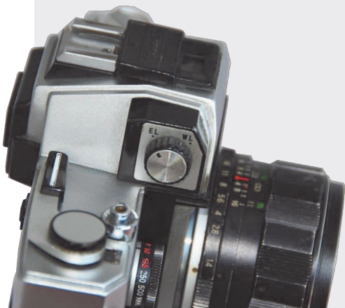
Vue sur le côté du prisme avec la commande EL ou WL ( Eye Level ou Waist Level). Au dessus on remarque le viseur de poitrine.
