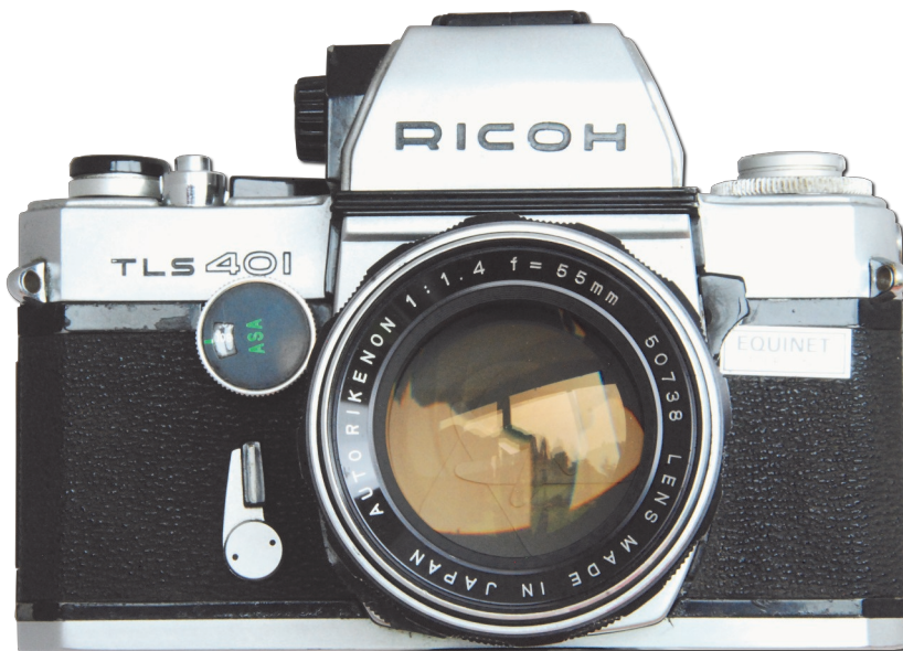
Ricoh TLS 401. On remarque le barillet des vitesses sur la face avant et le réglage de la sensibilité
