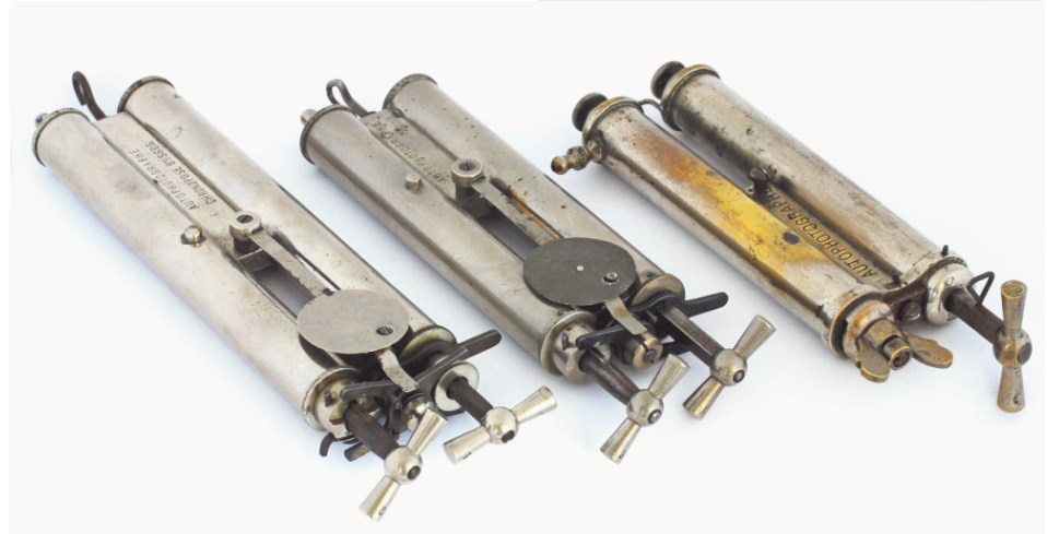
Figure 6 : Retardateurs Gravillon 1905 - 1906 comportant chacun les deux cylindres associés aux fonctions "retardement" et "déclenchement".
