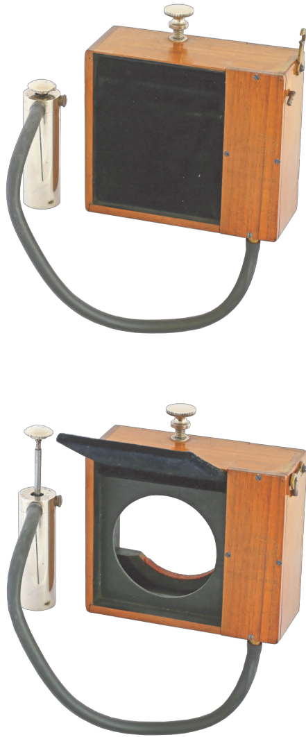
Figure 5 : Propulseur de Charles Monti monté sur un obturateur Guerry à un volet (pour les besoins de la photo celui-ci est maintenu ouvert pour simuler le fonctionnement).
