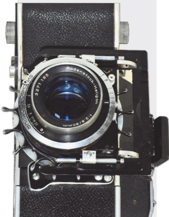
Perfo 608 équipé d'un objectif Rodenstock Héli-gon.
