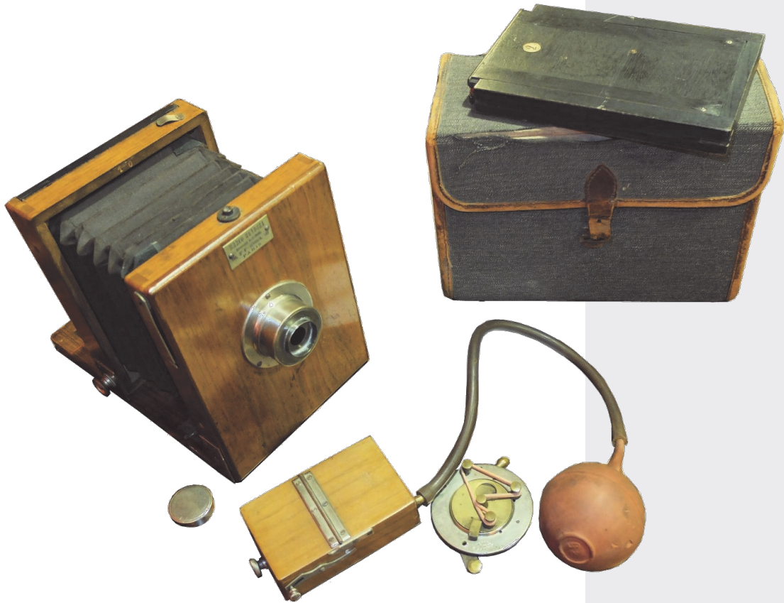
Petite chambre 9 x 12 MARCO MENDOZA avec trois types d'obturateurs : Simple bouchon - Circulaire à élastique - Vertical, genre 'tapette à souris' 1890
