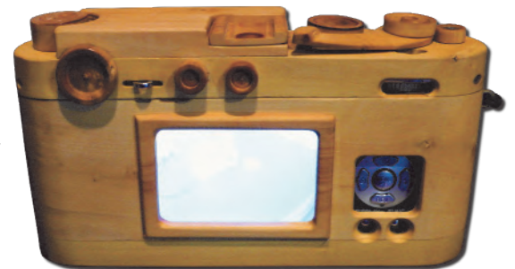
📷 Leica « numérique ». Arrière montrant l'écran et les commandes du Lumix.
