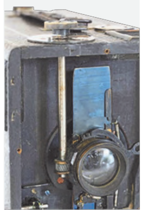
Photo 9 Déplacement de l'optique par pignon et crémaillère.
