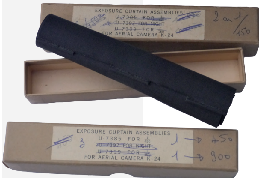
L'appareil était proposé avec plusieurs rideaux, chacun permettant d'obtenir une gamme de vitesses.
