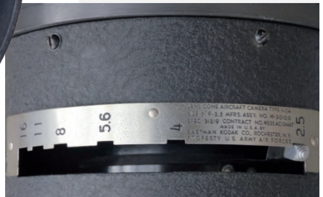
Détail de la commande du diaphragme : 2.5 / 4 / 5.6 / 8 / 11 / 16
