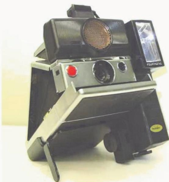
On commence par visser à l'aide de l'écrou de pied, la semelle porte accessoires sous l'appareil. Cette semelle permet la fixation d'un flash. Mise en place simple si c'est un SX 70 autofocus.
