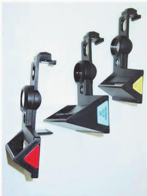
Les 3 compléments d'optique macro se clipsent sur l'avant de l'appareil et, lorsqu'ils sont en place la mise au point ne se fait pas comme à l'habitude. Une bonnette vient se placer devant l'objectif en modifie la focale. Ce complément comporte également un miroir qui renvoie et concentre la lumière du flash vers le sujet à photographier.
