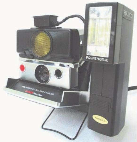
Si c'est un SX 70 alpha du fait de sa mise au point manuelle il faut y rajouter l'adaptateur de flash et, dans ce cas, régler la distance sur le minimum (26 cm).
