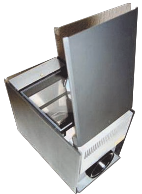
1972. Lampe halogène 24V 150W. Objectif Will Maginon F = 200 mm. Photo « collection particulière »
