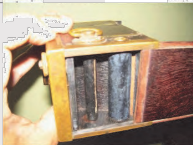
L'axe de bobinage du film semble fixe ce qui demande d'être en chambre noire pour retirer la pellicule. On distingue le tambour compteur sur la droite.
