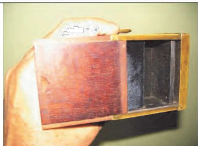
Les panneaux de côté se glissent indépendamment du fond ce qui confirme le côté amateur et le choix d'un mécanicien pour la fabrication de cet appareil.
