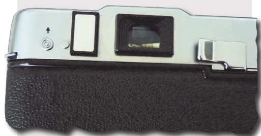
Bouton de verrouillage du levier de débrayage et compartiment de pile
