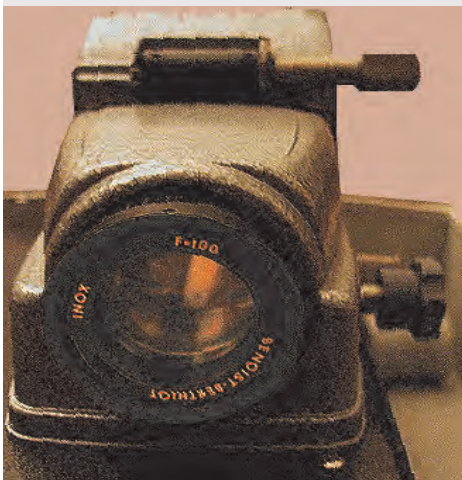
Prestige 250 Objectif Benoist Berthiot Inox F = 100 mm.
