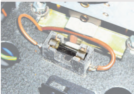
L'Elysée 2500 a un fusible et, qui plus est, un fusible facilement accessible !
