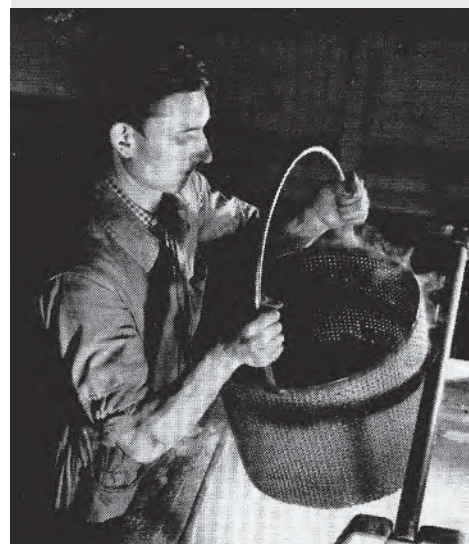
Traitement antirouille chimique.
