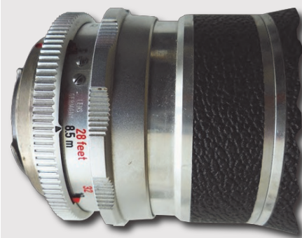
Echelle des distances du Super-Dynarex 4/200 mm sur 8,5 mètres
