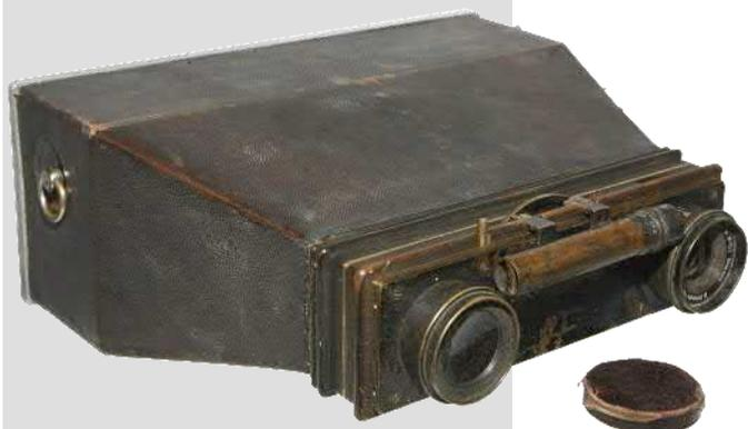
Photo-Jumelle 6½ x 9 modèle 1899 - magasin 18 plaques avec compteur Elgé - Mise au point - Vitesse variable (Gaumont)
