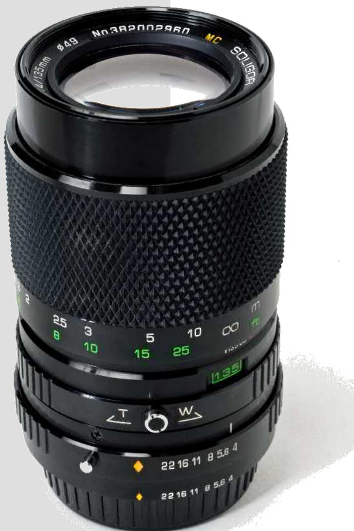
*Soligor 4/85+4/135. En enfonçant le bouton rond entre T et W, on libère la bague sélectrice de focales et on peut choisir entre 85 (en allant vers W) ou 135 (en allant vers T). Le blocage est automatique en fin de course. L'objectif est ici verrouillé sur 135 (mention qui apparaît en vert, un peu au dessus à droite). Aucun risque de fausse manœuvre !*
