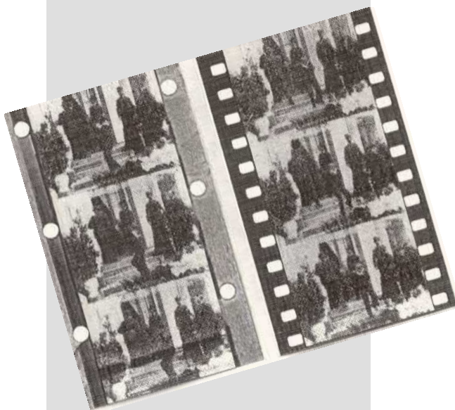
A gauche, film avec les perforations Lumière. A droite, les perforations Edison, qui, depuis plus de cent ans, sont le standard international.
