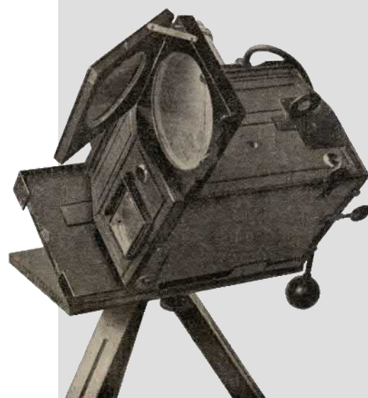
Jumelle stéréo 9 x 12 avec clisimètre
