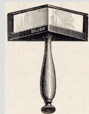
Equerre à prisme dans son écrin. Matériel acheté et revendu par la maison Bellieni
