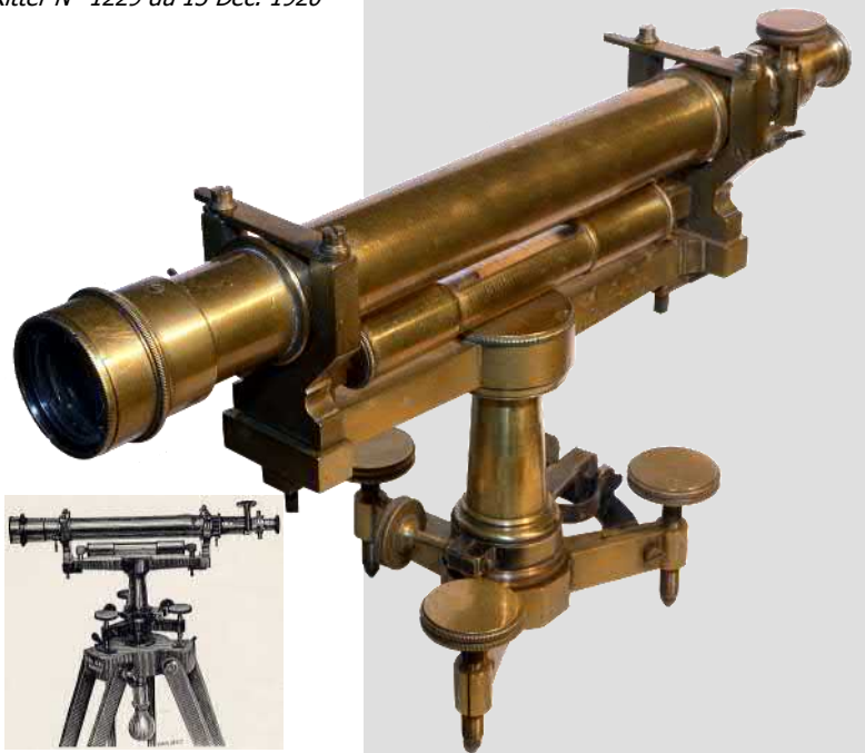
Niveau à lunette et à fiolle fixe perfectionnée. Modèle Bellieni Nancy (1872 / 1881)
