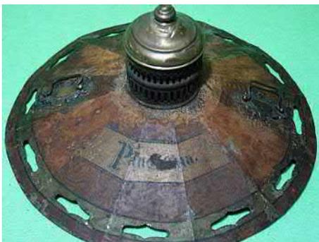
A la base du corps externe se trouve ce qu'on pourrait appeler le « moteur ». Ce serait un gros moteur à ressort en spirale de type horlogerie, d'où la clé externe pour le remonter. Il entraîne un axe en rotation. Un système d'échappement lui donne un mouvement discontinu ; lorsque le panier qu'il entraîne tourne d'un pas de vue, une petite sonnette retentit pour prévenir les spectateurs.
