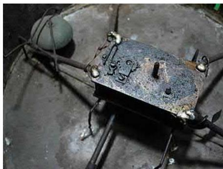
Le panier est entraîné en rotation par le moteur. Il fait défiler de manière intermittente 12 vues transparentes (certaines sont encore dans l'appareil).
