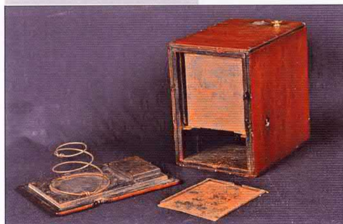
Photo n° 5 : Face arrière ouverte, partie coulissante sortie, manette (tirage de bas en haut) par la comman- de des plaques, bouton de déverrouillage latéral.
