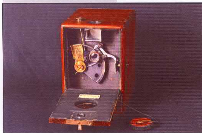
Photo n° 2 : Face avant ouverte, viseur, objectif, diaphragme et obturateur visibles.
