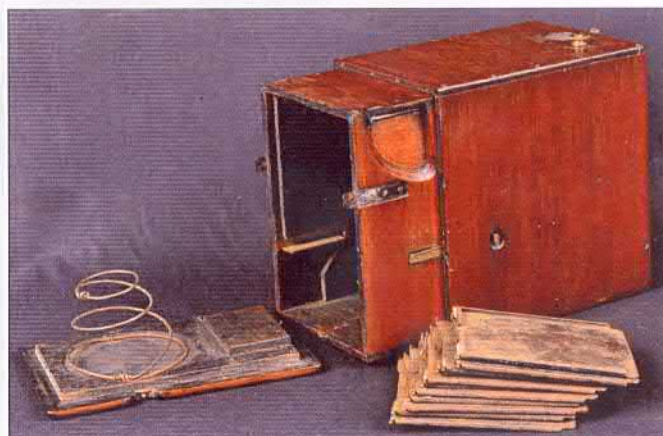
Photo n° 5 : Face arrière ouverte, partie coulissante sortie, manette (tirage de bas en haut) par la comman- de des plaques, bouton de déverrouillage latéral.
