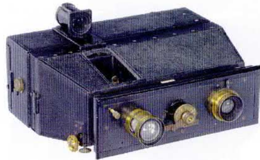
Jumelle Mackenstein 6,5x9cm à mise au point facultative c1895. Objectif de visée rotatif permettant de viser à 90°. Objectif de prise de vue C. Zeiss 8/110mm.
