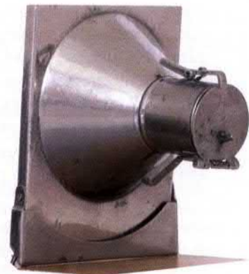
Vues avant montrant les systèmes d'obturation des appareils français et anglais.
