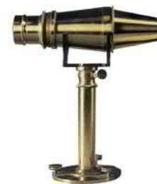
Figure 5 : Chambre métallique Voigtländer, munie de son objectif Petzval et de son cône de mise au point à loupe.
