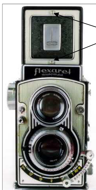
FLEXARET 9-131414 Meopta Belar: 3,5/80 12073 Meopta Belar: 3,5/80 237889 Prontor SVS: B,1s-1/400s avec EV. 2 ergots pour le cache
