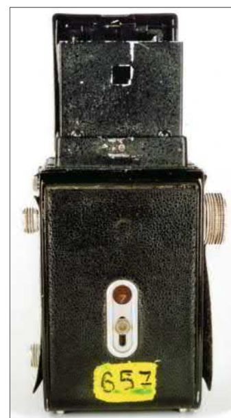
FLEXARET 0316591 Meopta Anastigmat 1:3 f=80mm 046793 Meopta Mirar 1:4,5 f=80mm 4712204 Prontor II B, 1-1/200 MEOPTA MADE IN CZECHOSLOVAKIA sur le capuchon du viseur
