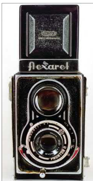
FLEXARET 0316591 Meopta Anastigmat 1:3 f=80mm 046793 Meopta Mirar 1:4,5 f=80mm 4712204 Prontor II B, 1-1/200 MEOPTA MADE IN CZECHOSLOVAKIA sur le capuchon du viseur
