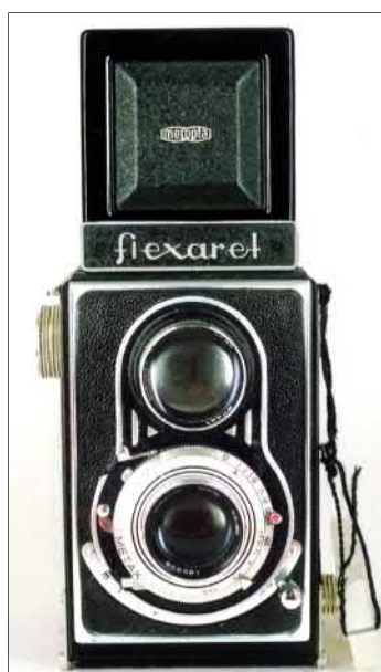
FLEXARET Meopta Anastigmat 3/80 97441 Meopta Belar 3,5/80 190338 Metax B, 1-1/400 MEOPTA sur le capuchon du viseur
