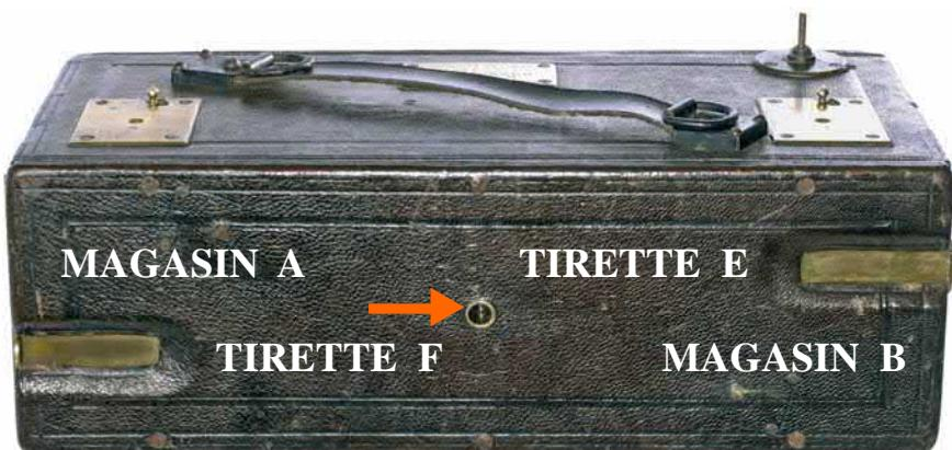
Les légendes sur cette photographie de la face arrière indiquent où sont positionnés respectivement les magasins et les tirettes permettant de les déplacer. La flèche rouge indique l'orifice tubulaire au fond duquel on peut voir une marque rouge lorsqu'un des magasins occupe l'espace central. On réalise également que l'inventeur a décalé verticalement les tirettes ce qui n'était pas visible à la page précédente sur la coupe horizontale.
