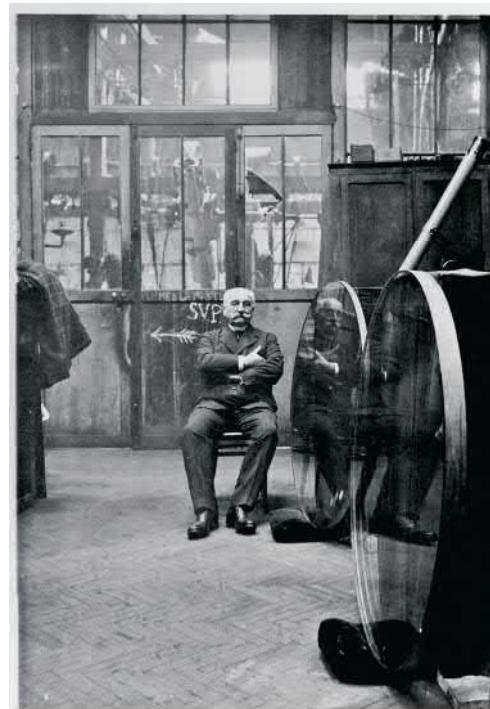
Monsieur Numa Parra pose à côté des deux lentilles destinées à un objectif de grande dimension (> 1 m de diamètre). Il se peut que ce soit celui de 1,05m de l'observatoire de Yerkes. La lentille au premier plan est un verre Crown, l'autre est un Flint.
