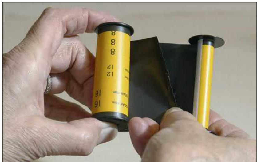
Au cours de ces manipulations, il est possible que se produise un léger glissement du film par rapport au papier. S'il n'excède pas un ou deux millimètres, on peut décoller l'adhésif et le remettre en place pour compenser le décalage. Au-delà, il vaut mieux recommencer l'opération en veillant à ne pas écarter les bobines pendant les enroulements et à ne pas laisser de mou entre la pellicule et le papier. Ici, la bande adhésive est un peu pliée, il faudra la déplacer de deux millimètres
