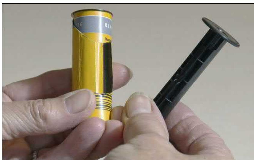
Le rembobinage sur le noyau de 620 est terminé, le film est prêt à être utilisé dans un appareil de collection.
