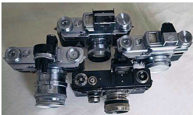
15. De g. à dr. : Contax II Sonnar 2/85 viseur 436/7, Contax III Sonnar 1,5/50 viseur Albada 433/26, Contax I Sonnar 1,5/50 viseur Albada 433/24 et Contax III Tessar 8/2,8 viseur 432/3.
