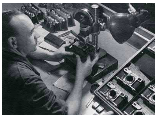
10. Contrôle de la fenêtre d'exposition sur le Contax II
