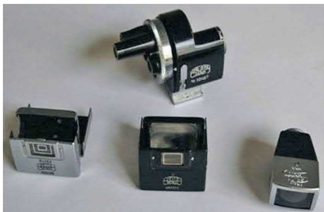
13.. Viseurs 436/7 pour 35, 50, 85, 135 et 180mm, Albada 433/26 pour 50 et 135mm et 432/3 pour 28mm.
