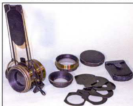
Obturateur simple à guillotine, l'exposition se règle par différents élastiques, ca 1883
