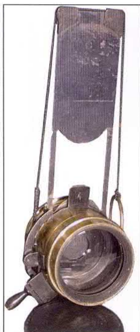
Obturateur simple à guillotine, l'exposition se règle par différents élastiques, ca 1883
