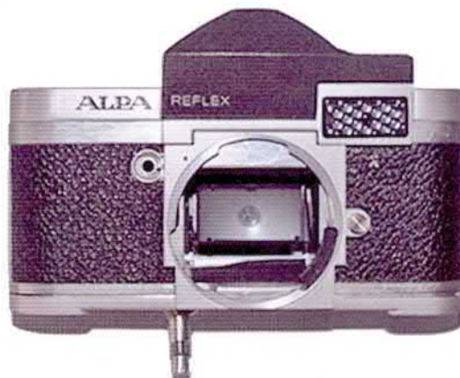
Etude d'appareil technique, avec déclencheur sous la semelle, sur base Alpa 6c.
