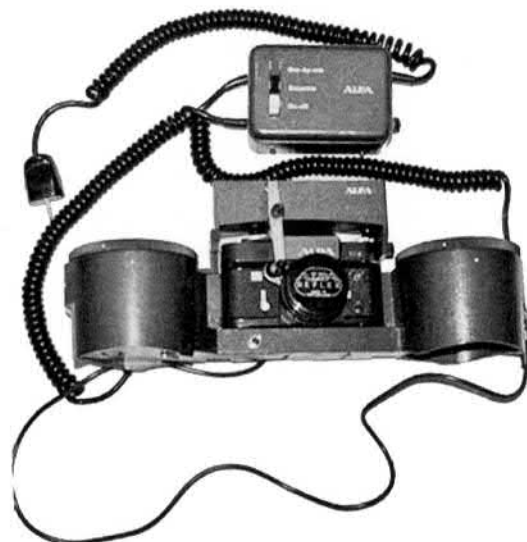
Ensemble Alpa 10d, Schneider Curtagon 2,8/35, moteur Tenmotor, dos magasin 30m, Alpadomi pour 24x36 et 18x24mm et alimentation, ci-dessous, vue intérieure, en haut et vue arrière avec compteur de vues et réglages du format, en bas.
