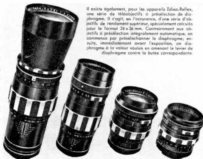
Il existe également, pour les appareils Edixa-Reflex, une série de téléobjectifs à présélection de diaphragme. Il s'agit, en l'occurrence, d'une série d'objectifs de rendement supérieur, spécialement calculés pour le format 24 x 36 mm. Contrairement aux objectifs à présélection intégralement automatique, on commence par présélectionner le diaphragme; ensuite, immédiatement avant l'exposition, on diaphragme à la valeur voulue en amenant le levier de diaphragme contre la butée correspondante.
