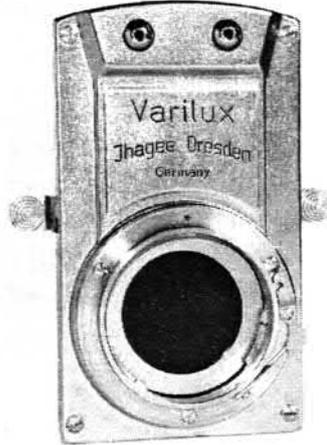
*Élément de mesure "en place" pour la mesure de la lumière. (la plaque sensible et les poussoirs sont en position basse)*
