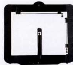
Viseur Huillard équipé de fils pour contrôler le niveau de l'appareil
