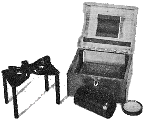
Fig 3 Stéréoscope Matthey, deux lentilles à écartement réglable.
