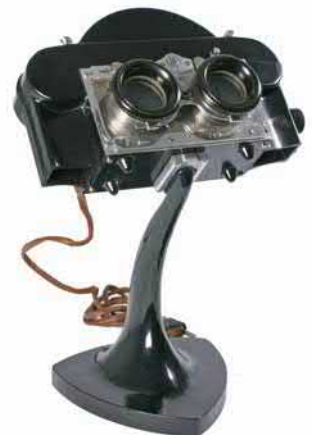
Stéréoscope Inverseur en bakélite (alimentation par le secteur) par J. Richard, pour vues prises avec le Verascopie F40. 1953
