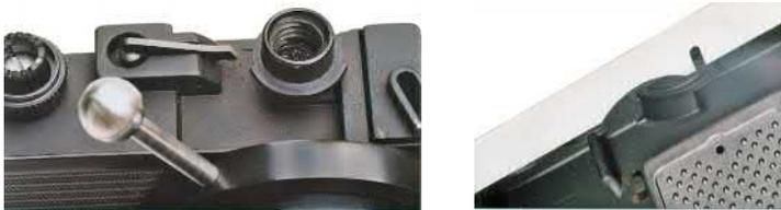
*(A gauche, la came permettant le débrayage de l'entraînement et à droite le rehaussement interne agissant sur la came.)*
