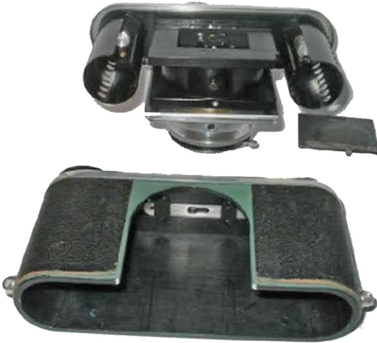
Cet ensemble, dos+semelle est taillé dans la masse. C'est un bloc de matière que je pense être de l'aluminium qui a été creusé: on aperçoit les traces de l'outil de fraisage. Ce dos, qui revient aussi sur les cotés de l'avant, est recouvert d'un fin cuir noir et une semelle rapportée en alliage poli vient finir le dessous.
