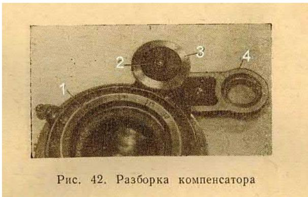
Рис. 42. Разборка компенсатора
