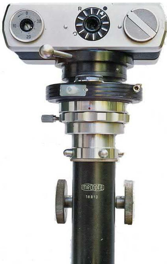
*(L'objectif est remplacé par une rallonge comprenant l'obturateur et une bague fixe d'adaptation à un raccord de microscope. La partie arrière comprend l'obturateur à 3 lamelles et, sur le bord externe, une prise pour flash protégée par un capuchon en plastique transparent souple. La partie avant, chromée, présente une gorge pour le blocage sur l'adaptateur. Le corps de l'appareil ne présente pas d'œillets de courroie.)*
