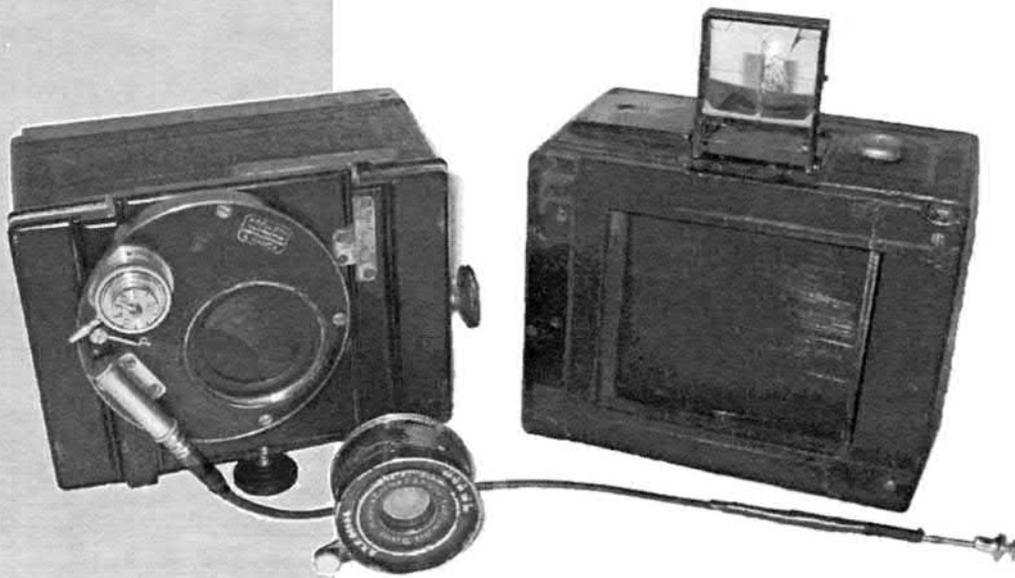
Boîtier avec objectif dévissé et magasin déposé.
