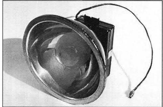
*1. Kodéclair vu de face. L'ampoule est une ampoule classique au tungstène, de taille équivalente à une PF 100.*
