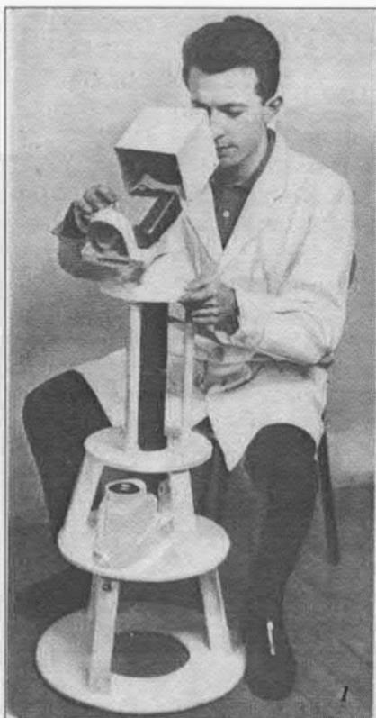
1. Vérification de la position de l'objectif de base par rapport au plan-film à l'autocolimateur.
