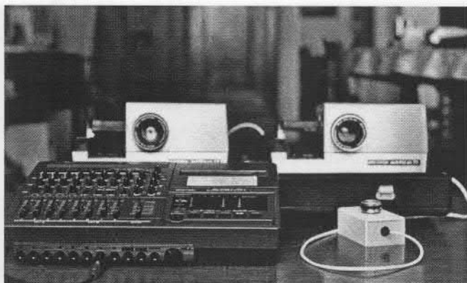
L'enregistrement du signal de synchronisation sur magnétophone à cassettes multipistes (Fostex).
