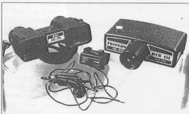
La recherche des stations se fait par un bouton moleté situé dessous le récepteur ; le réglage du volume est à deux positions, haute et basse. Le récepteur est alimenté par trois piles LR-44 dont le logement, muni d'un interrupteur marche et arrêt, est placé sur le fil de l'écouteur que l'on branche à l'aide d'une prise jack. Ce fil sert également d'antenne.
