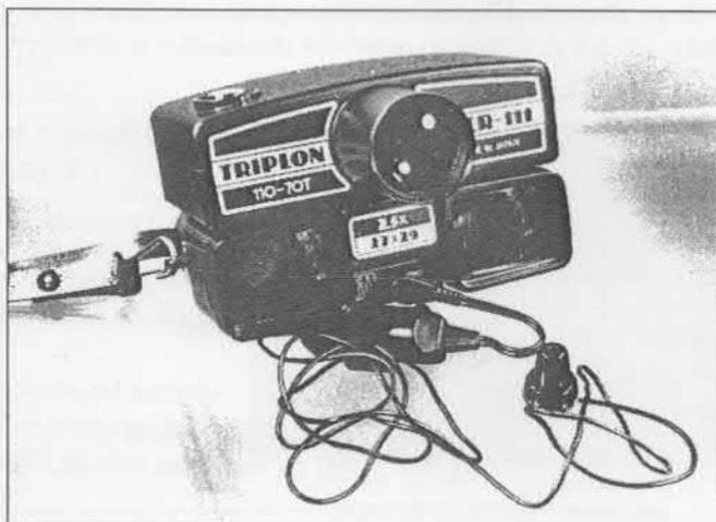
La partie récepteur radio FM vient se loger entre les optiques de la jumelle. En FM, la gamme d'ondes va de 88 à 108 MHz.
