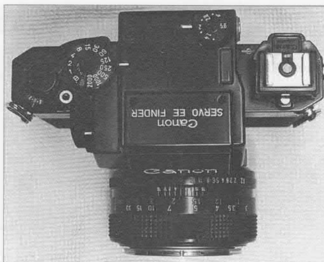
Canon F1 avec Servo-visueur EE (servo-finder EE)
