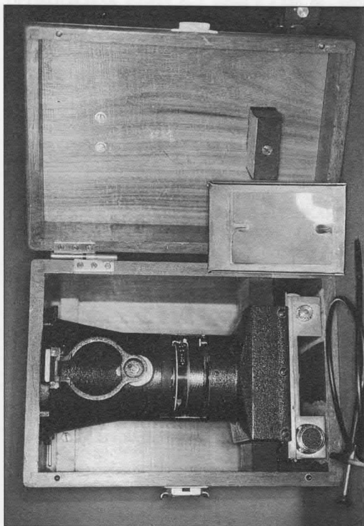
L'appareil dans un coffret avec dépoli de mise au point
