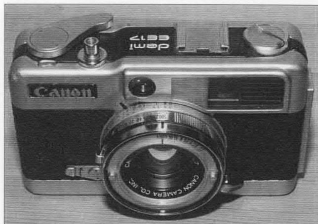
Équipé d'un objectif Canon SH 30 mm f; 1,7, il abandonne le système à cartouche Agfa Rapid pour revenir au chargeur classique de 35 mm.
