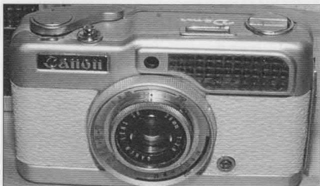
Son objectif est un Canon SH 28 mm f; 2,8. L'obturateur SEIKO L. 2000 donne en continu des vitesses entre le 1/30° et le 1/250° ainsi que la pose B. Il est équipé d'une cellule au sélénium en nid d'abeille ; elle admet des sensibilités allant de 10 à 400 ASA. Les vitesses et les diaphragmes sont couplés. Le réglage de l'exposition se fait par un système de coïncidence d'index situé sur le dessus du boîtier. L'éventail des diaphragmes va de 2,8 à 22.
