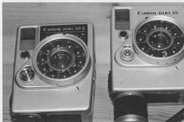
C'est le dernier des 18 x 24 de Canon. Il ne se distingue que de peu du Dial 35 de 1963. La cellule donne une gamme allant de 10 à 640 ASA avec l'assistance d'une pile HD. La griffe porte accessoire comporte un contact central qui permet la synchronisation du flash. Aucune autre nouveauté en dehors de la face avant modernisée n'est apportée à ce modèle.
