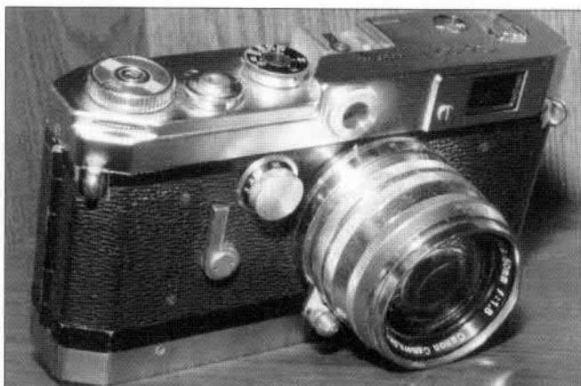
Ouverture du volet arrière et verrou en bas et à gauche. Pas de vis du tripode inclus dans la manette du verrou à gauche; Obturateur focal en acier inoxydable. Argenture du double prisme du télémètre. Identification en bas et à gauche : « MODEL Vt de Luxe ». Armement par système TRIGGER sous le boîtier.
