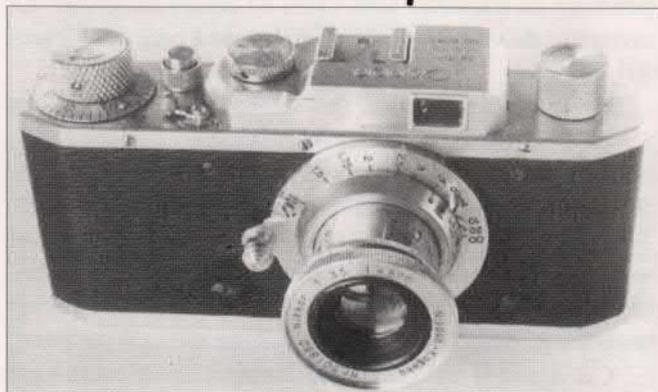
Objectif Nikkor 50 m/m f ;3,5. Le télémètre est supprimé, seul le viseur est visible sur le dessus du boîtier. Le sélecteur de vitesses lentes est également supprimé, laissant la place ainsi à l'éventail de vitesses allant de la pose B puis du 1/20<sup>e</sup> à 1/500<sup>e</sup>.
