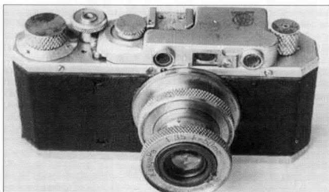
Premier appareil construit par la SEIKI KOGAKU KENYUSHO. L'objectif est un 50 mm f/3,5 Kaysapa. Le boîtier comporte un seul sélecteur de vitesses qui s'échelonnent de 1/8<sup>e</sup> à 1/500<sup>e</sup>. Il comprend la pose B. Le
