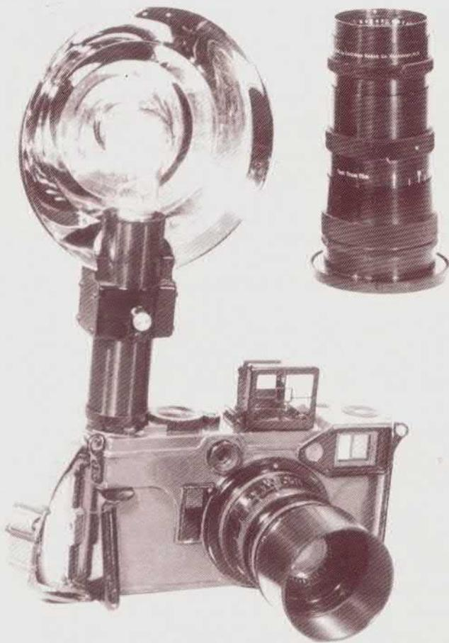
Photo 3 : Le 70 mm Combat Graphic vu avec son flash monté. L'Ektar de 101 mm est sur l'appareil avec son parasoleil, et le télé de 203 mm est en dessous. Le flash est du type à condensateur, technologie populaire dans les années 50 et il accepte les lampes à vis et à baïonnette.
