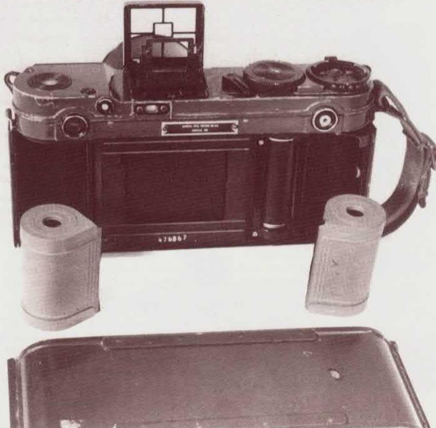
Photo 5 : Vue de l'appareil avec le dos et les cassettes enlevés. Le film se déplace de gauche à droite, mais le rideau en nylon caoutchouté va de droite à gauche. l'extrême gauche, on voit l'ocilleton du viseur-télémetre, le bouton libérant le coupe-film, la fenêtre du compteur de vues et le déclencheur tout à fait à droite.
