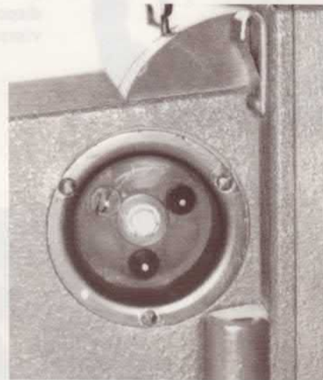
Photo 4 : Sabot du flash à baïonnette sur le côté droit du boîtier. Les piles sont placées au fond du boîtier lui-même.
