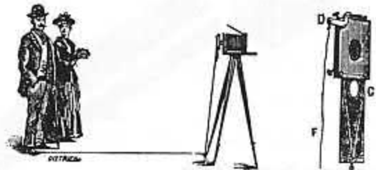
Obturateur photographique fonctionnant à distance, et permettant de faire son portrait soi-même.
