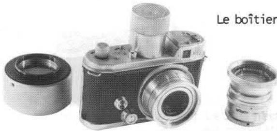
Le boîtier comporte autour du filetage de montage de l'objectif, une bague à baïonnette pour un usage spécial (?). L'objectif courte focale f/30mm Schneider-Xénagon ouvre à 1:3,5 diaphragme classique à mise au point fixe, ainsi que le Télé-Xénar 1:3,8 de f/75mm; double prise synchro. frontale; parasoleil vissant avec filtre genre U.V. incorporé.
